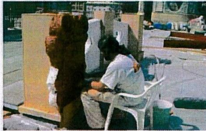
(F-170, F-171) Trabajos de esculpido para obtención del molde
